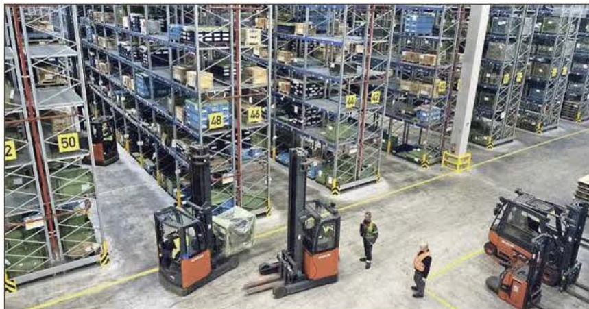
Ausgestuftes System: In der Ötigheimer Regalanlage werden ausschließlich Elektro-Stapler mit WLAN-Verbindung eingesetzt.
